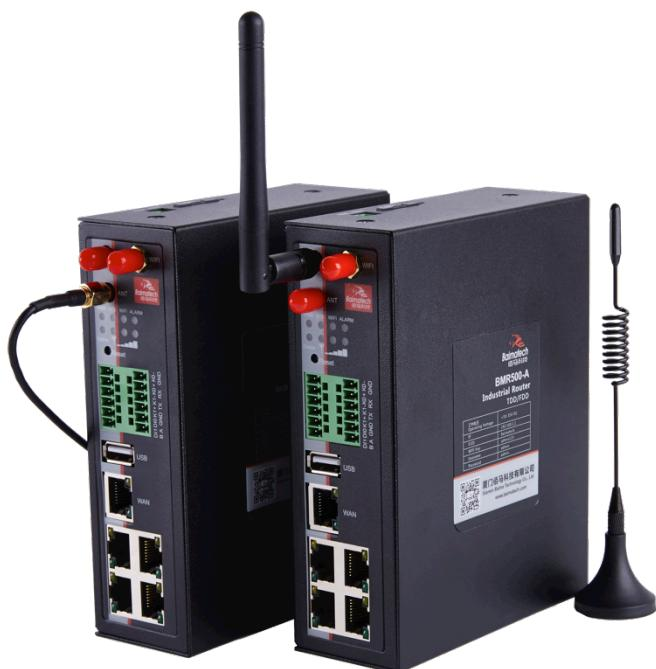
BMR500 是一款物联网工业级无线路由器，利用全网通/4G/3G/2.5G 运营商网络为用户提供高速无线网络。该产品采用高性能的工业级 32 位通信处理器和工业级无线模块，集全网通、高速路由、WIFI 覆盖、本地存储等旗舰功能于一体，为苛刻的无人值守现场提供永远在线的通信网络。通电即可组网，为遍布各地的远程设备与管理中心之间组建坚强无线通信网络，方便快捷。被广泛应用在远程数据采集、远程设备监测、远程控制、远程报警等领域。在大型设备监测、污染源视频监控、金融自助、交通卡口抓拍等大数据量远程传输场合应用优势明显。
