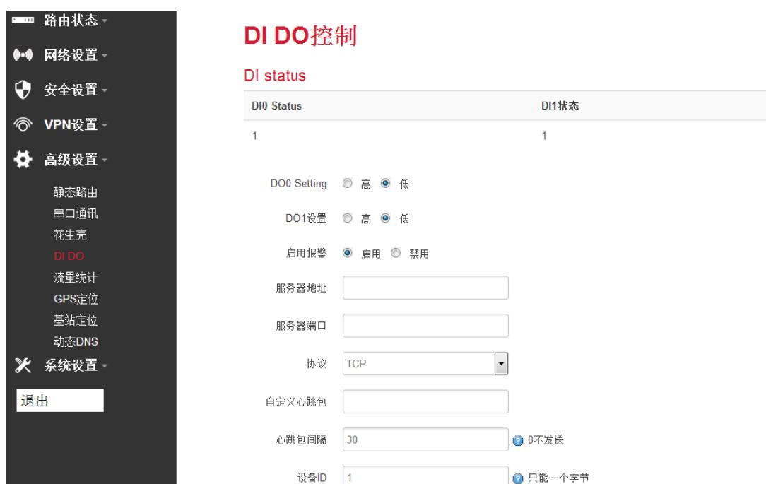
同时，BMR500 的 DI/DO 功能还支持报警模式，即用户可设置好服务器的地址和端口等信息，网关在接受到 DI/DO 口的电平变化时，自动触发报警，并将当前电平发送往服务器。
