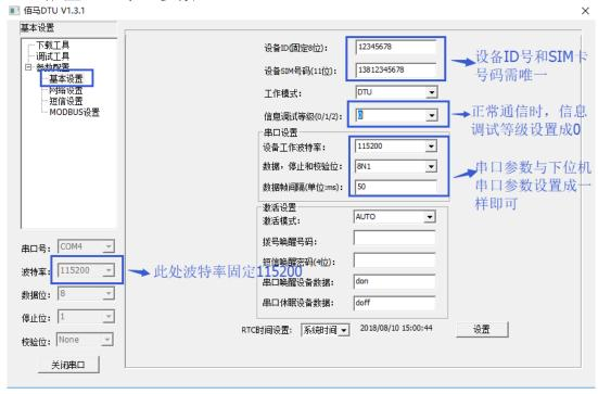
⚠ 注意: 左下角的波特率为配置的波特率,固定 115200,不可以改动。在右边的"设备工作波特率"必须与下位机的串口参数设置成一样。
